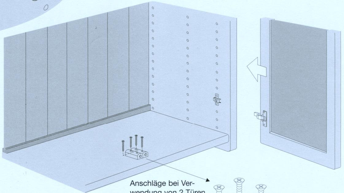
Anschläge bei Verwendung von 2 Türen
